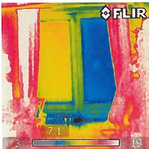
Billederne herunder viser en termorude der er gået th samt koldt træk
